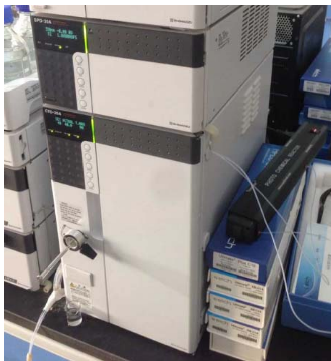
图 1：液相色谱-柱后光化学衍生-荧光检测器检测磺胺装置连接图
